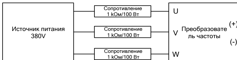
Рисунок 7-1 Пример схемы зарядки приводного устройства 380 В
